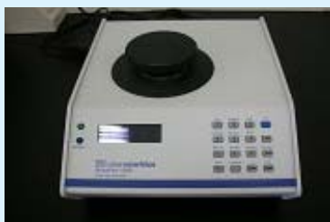
Pycnometer (Model No: AccuPyc 1330; Micromeritics Co., USA)
