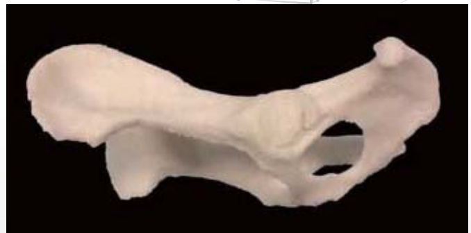
圖 2.（左）列印完成的實物，仍在列印底板上，且尚未拆除支架 （右）拆除所有支架後所剩下的列印目標產物
