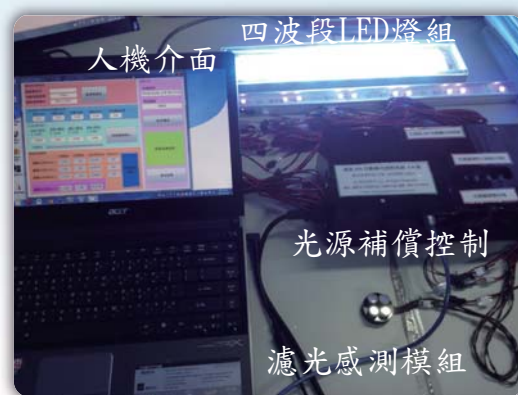
圖三 植物生長光源補償系統測試
