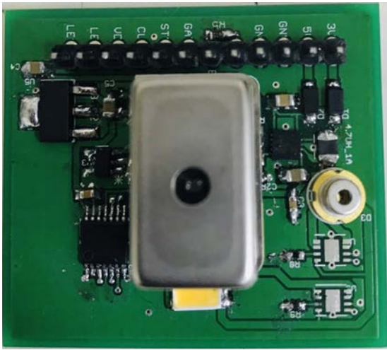
圖 1：微光譜儀 PCB，作為 LinkIt 7697 IoT 和可攜式 DNA 檢測系統的模組接口。
