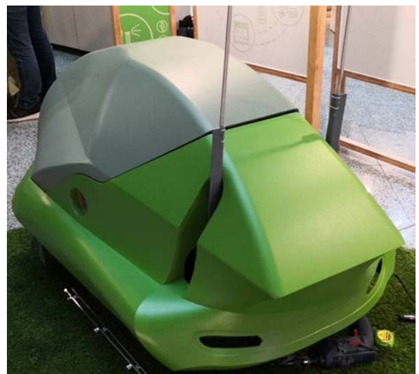
圖 3：使用 GPS 跟踪和數據採集系統測試、肥料噴灑車的車輪控制和最終車體。
