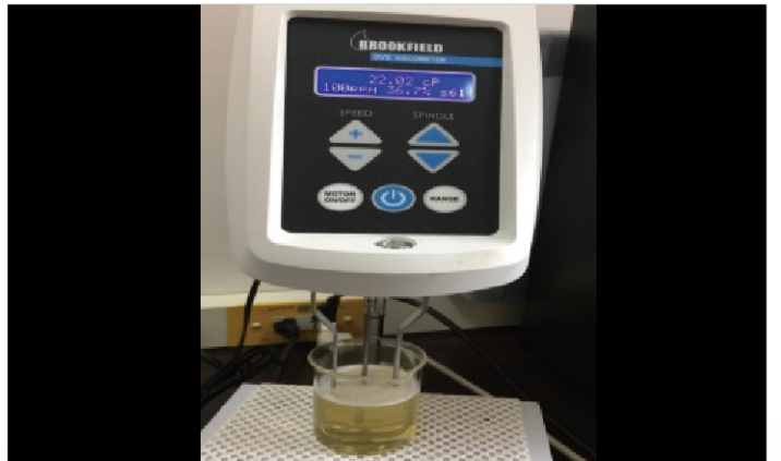
圖6. 精油洗髮精露產品雛形。以布式黏度計測定其黏度，在特定轉子及轉速下為22.08cP，將在製程未來標準化後確定產品黏度標準。
