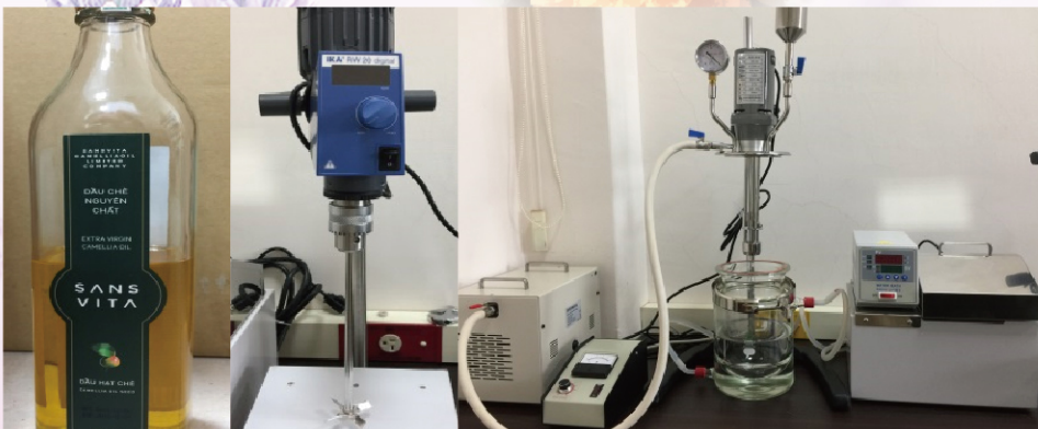
圖3. (左)以高品質苦茶油為植物油原料之一，進行皂化反應，製造脂肪酸鉀鹽的天然清潔成分。(中)清潔本體搭配活性成分及增稠劑，進行攪拌製作洗髮精。(右)苦茶油搭配乳化劑及助乳化劑進行乳化反應，輔以精油及維生素活性物質，製作護髮乳液。
