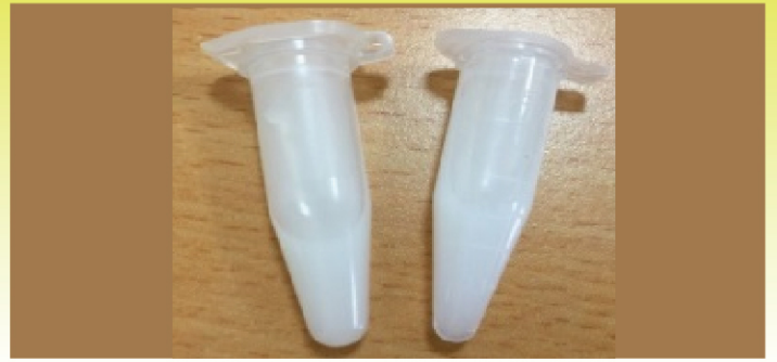
圖5. 精油護髮乳液產品以3000rpm離心30分鐘，離心前後(左及右)產品外觀不變，表示產品具有一定安定性。
