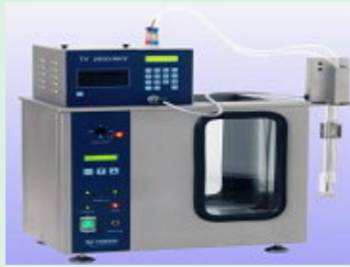
黏度測定儀 (型號：TV2000-AKV: 荷蘭 Tamson Co.)
