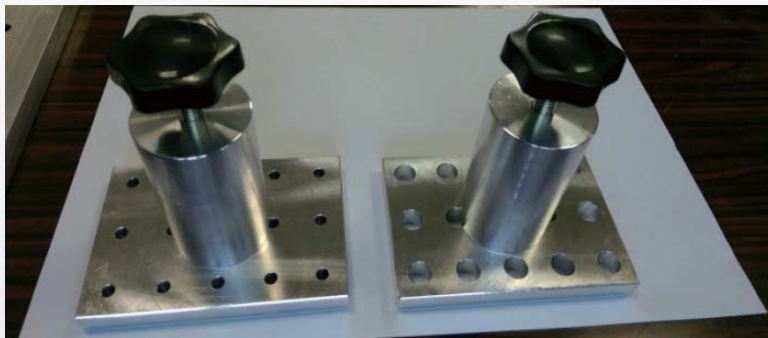
圖4. 不同粗糙度或蜂窩形狀的印刷模型版
