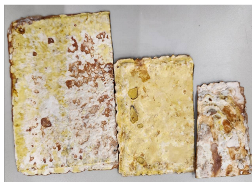
圖 2：採收後化學處理後真菌布料複合皮革原料
